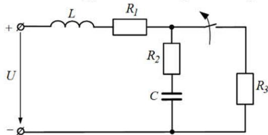
3. Используя методы расчета переходных процессов в электрических цепях постоянного и переменного тока определите то переходный ток  $i_2$ , если  $R_1 = R_2 = 10 \text{ Ом}$  и переходный ток  $i_3 = 4e^{-100t} \text{ А.}$  (ОПК-4.1)
