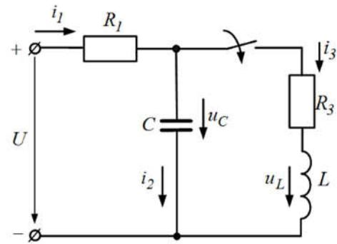
2. Используя методы расчета переходных процессов в электрических цепях постоянного и переменного тока записать характеристическое уравнение цепи при размыкании рубильника. (ОПК-4.1)
