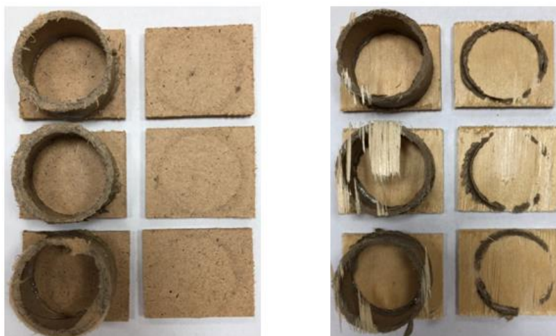
Рис.2. Образцы с наружными слоями из MDF и фанеры после испытания на определение прочности при отрыве
