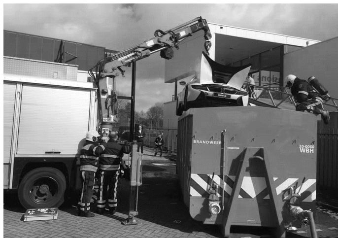
Рис. 1. Пожарные погружают BMW i8 в ванну с водой
