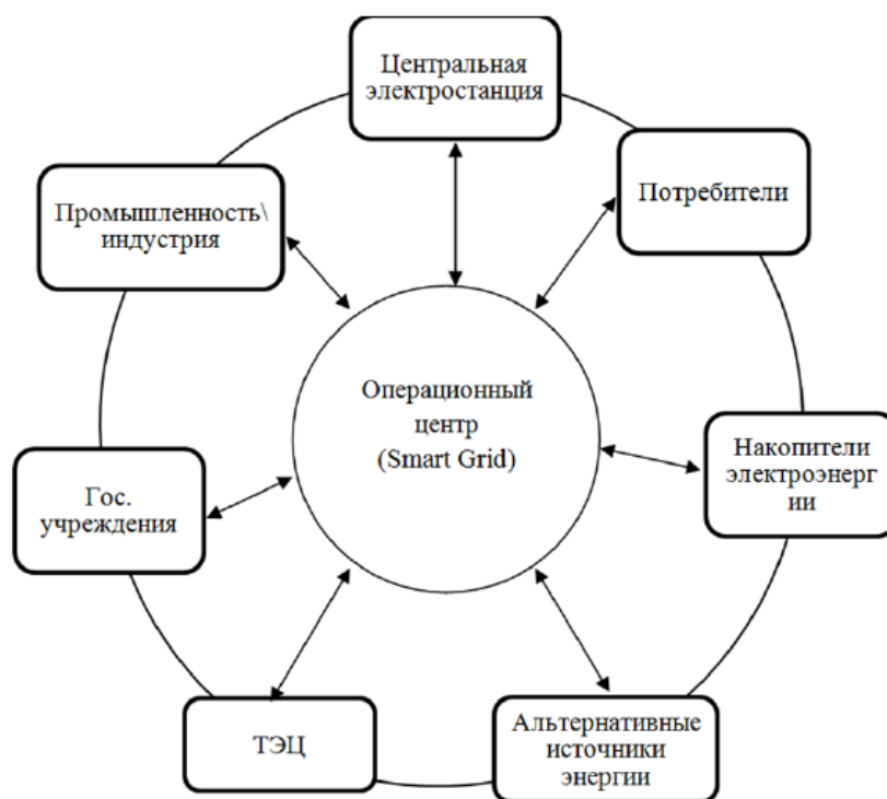
Рис. 3 – Архитектура Smart Grid
