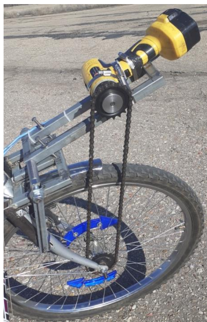
Рис. 8. Установка шурупверта на крепление
