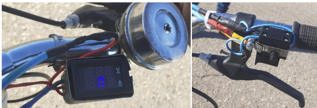
Рис. 9. Установка ампер – вольтметра (слева) и кнопки включения/выключения электропривода (справа) на велосипеде
