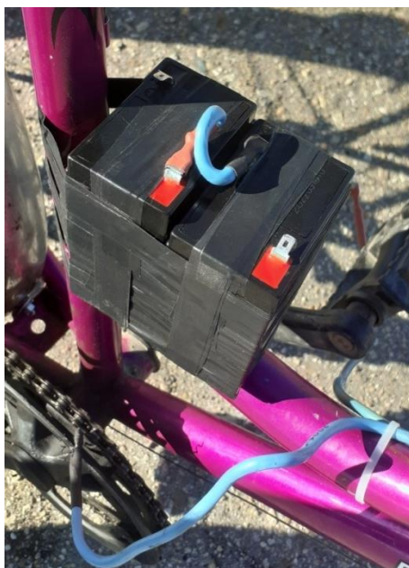
Рис. 5. Установка батареи аккумуляторов на велосипед
