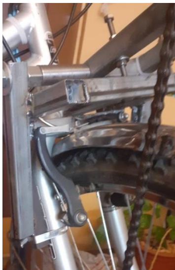
Рис. 7. Установка крепления электропривода
