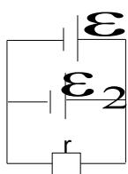
силы тока в реостате и в источниках тока, если два источника тока  $\epsilon_1 = 12$  В с внутренним сопротивлением  $r_1 = 4$  Ом и  $\epsilon_2 = 8$  В с внутренним сопротивлением  $r_2 = 2$  Ом, а также реостат сопротивлением  $r = 20$  Ом соединены, как показано на рисунке. (ОПК-1.2)
