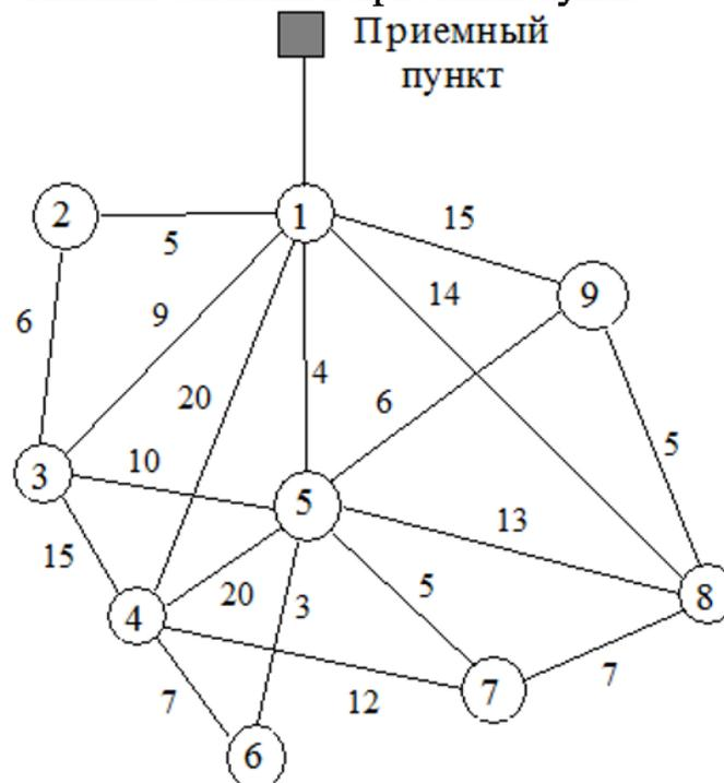
Применяя алгоритм Прима, постройте сеть трубопровода, соединяющего все скважины с приемным пунктом и имеющую минимальную общую длину труб.
