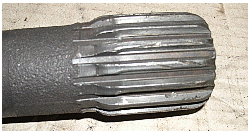
Рис. 1. Смятие шлицов полуоси
