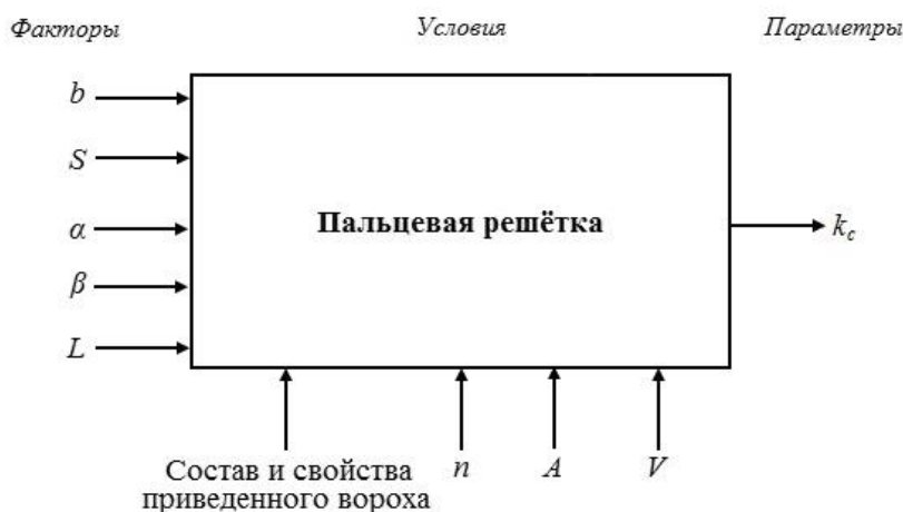
Рис. 1. Блок-схема кибернетической модели системы: b — ширина щели; S — шаг установки рабочих элементов пальцевой решётки; \alpha — угол установки скатов к горизонтальной плоскости решётки; \beta — угол установки пальцевой решётки, относительно стрясной доски; L — длина пальцевой решётки; n — частота колебаний пальцевой решётки; A — амплитуда колебаний пальцевой решётки; V — скорость воздушного потока, создаваемого вентилятором; k_c — коэффициент прохода зерна
