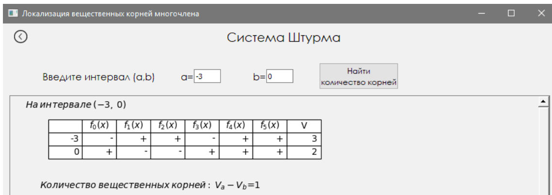
Рис. 2. Определение количества вещественных корней на запрашиваемом промежутке
