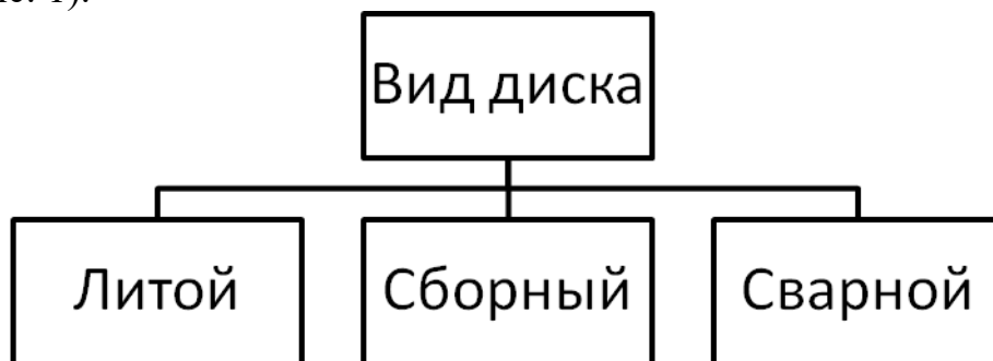
Рис. 1. Комплектование ротационных борон по видам дисков
