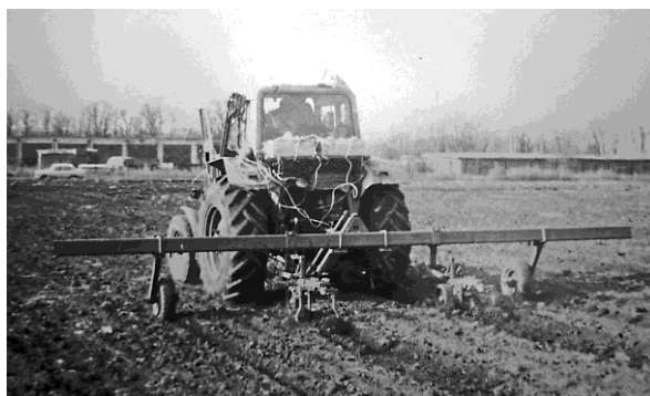
Рис. 3. Измерение энергозатрат на обработку почвы по следу колес
