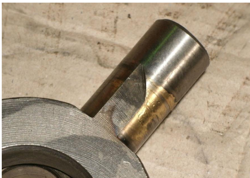
Рис. 2. Крестовина дифференциала со следами износа
