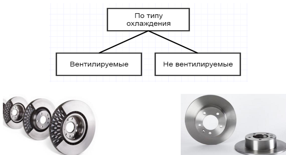
Рис.4. Виды тормозных дисков по способу охлаждения
