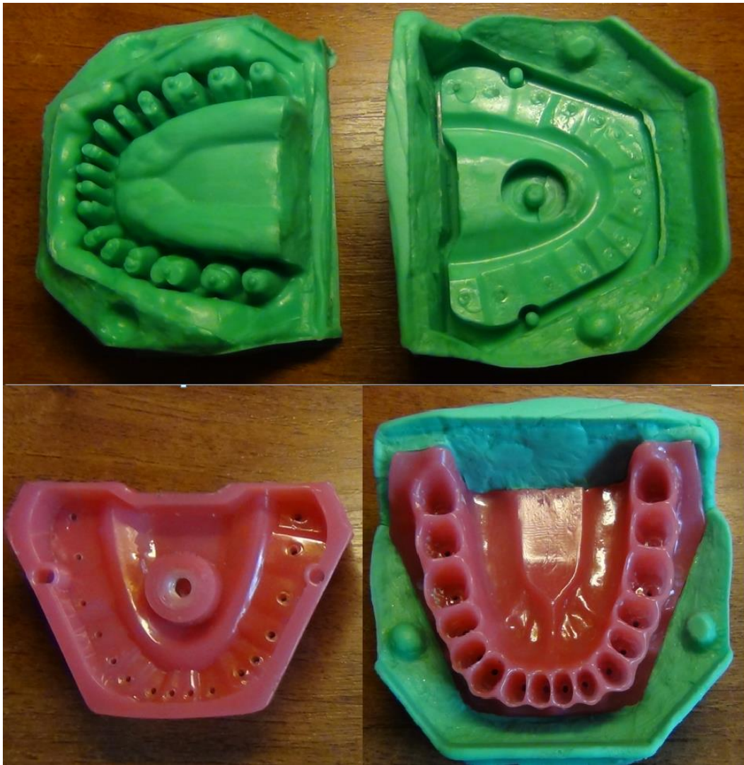
Рис. 7. Эластичная форма для литья пластикового основания дента-модели
