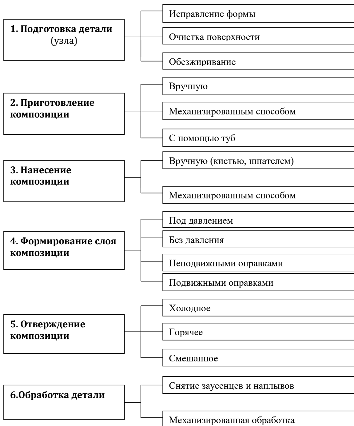
Рис. 2. Схема технологического процесса ремонта и модернизации деталей ремонтными композиционными материалами
