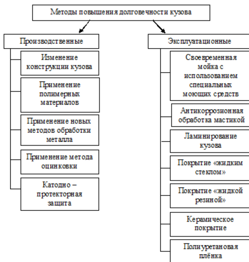
Рис. 1. Классификация методов повышения долговечности автомобильных кузовов
