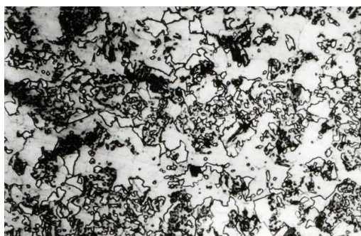
Рис. 1. Оптическая микрофотография структуры зернистого бейнита \times 800.
