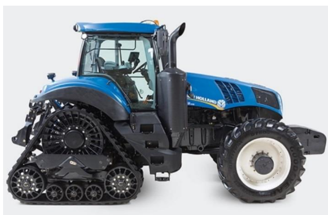
Рис.1. Наиболее встречаемые виды движителей: колесный, гусеничный (металлический и резиновый), полугусеничный
