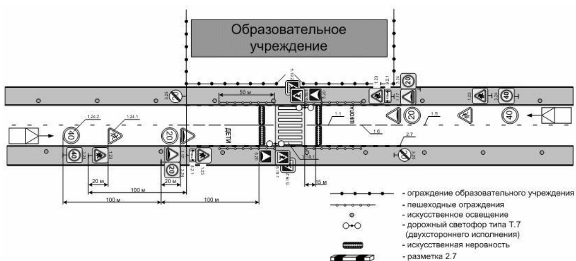
Рис. 3. Типовая схема организации дорожного движения на нерегулируемом пешеходном переходе в непосредственной близости от образовательного учреждения при двухполосном движении ТС
