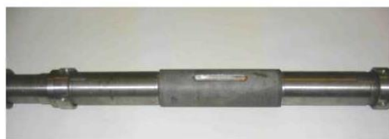
Восстановленное посадочное место вала под рабочее колесо центробежного насоса.
