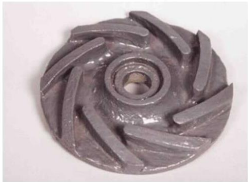
Восстановленное рабочее колесо центробежного насоса.
