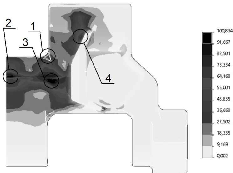
Рис.3. Эквивалентные напряжения (МПа), опорный участок, верх звена
