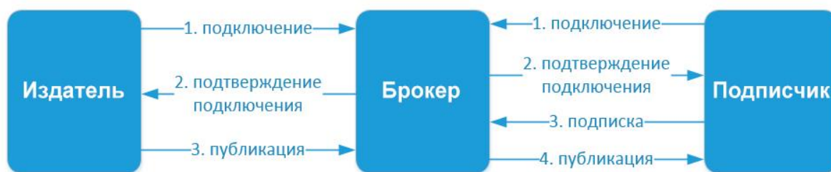
Рис. 1 – Принцип работы MQTT протокола.
