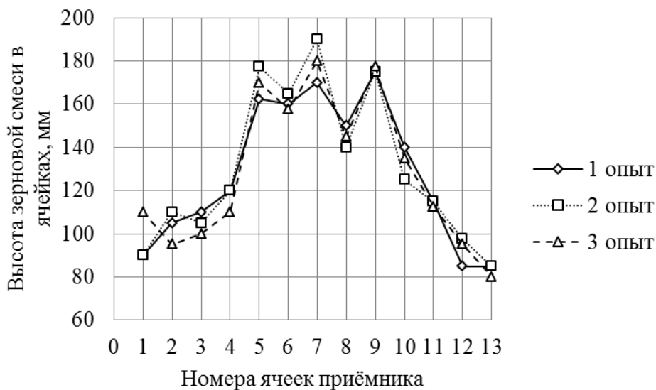
Рис. 6. Распределение зернового материала по ширине сепаратора (делители смещены к боковым сторонам на 10 мм, средний коэффициент вариации равен 0,27)
