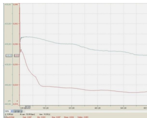
Рис. 2. Изменение коэффициента трения со временем покрытия DLCPateks (TRB-S-DE, CSM-Instruments, Швейцария)
