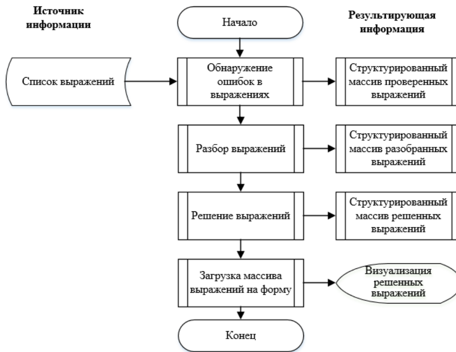
Рис. 3. Схема функционирования программного продукта
