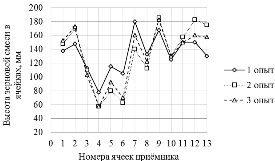
Рис. 5. Распределение зернового материала по ширине сепаратора при начальной установке делителей потока
