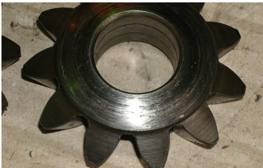
Рис. 3. Сателлит дифференциала с изношенной сферической опорной поверхностью
