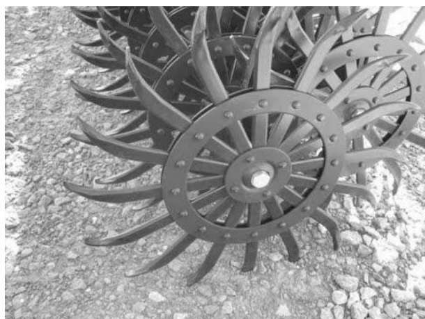
Рис. 4. Рабочий орган ротационной бороны - сборный диск
