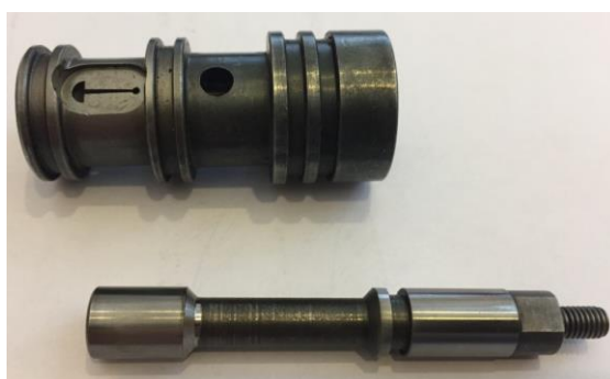
Рис. 8. Плунжерная пара (баррель и плунжер) подачи топлива ТНВД (№ 3077526) двигателей Cummins KTA 50, KTTA 38 (Cummins Inc., США)
